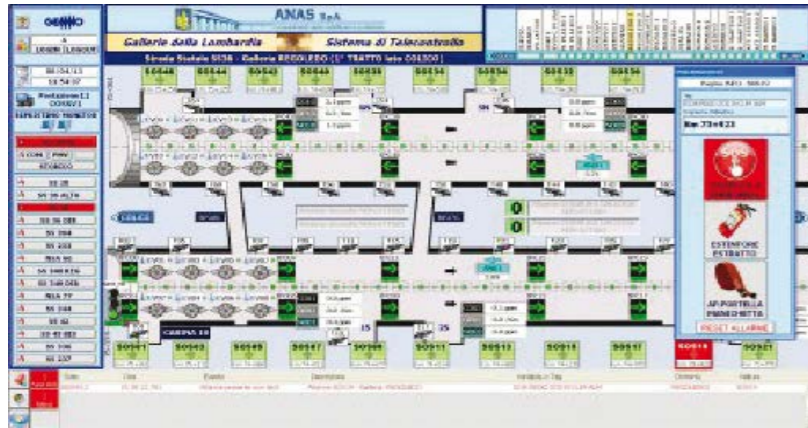
Fig.4 - Page principale des alarmes représentant le tunnel complexe de Regoledo
